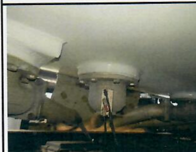
Détail clapet de fond
