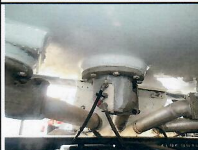
Détail clapet de fond
