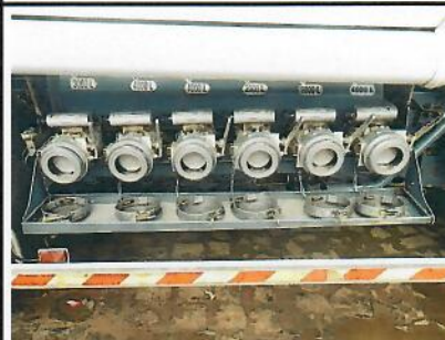
Détail vannes de dépotage
