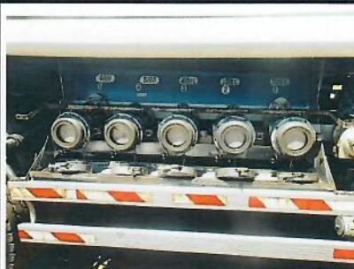
Détail vannes de dépotage
