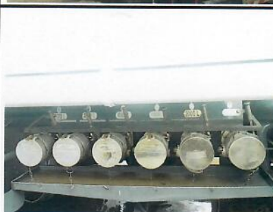
Détail vannes de dépotage
