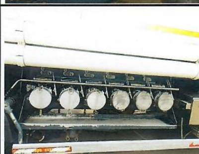
Détail vannes de dépotage
